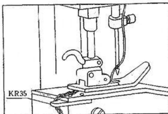
Перед началом шитья необходимо на ненужном мешке сделать пробный шов длиной не менее 50 мм. Так как шов образуется одной нитью, он может легко распуститься, и чтобы этого избежать с обоих концов шва следует оставлять запас нити примерно 50 мм. После зашивания каждого мешка цепочка ниток должна быть затянута и обрезана нитеобрезателем R35 таким образом, чтобы всегда оставалась на машине цепь нити длиной около 50 мм для зашивки нового мешка.
